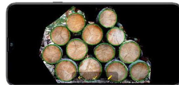
Durante la misurazione si scatta una foto della catasta di legname. Nell'immagine risultante, un algoritmo rileva automaticamente i tondi (possono essere corretti manualmente se necessario) e in base alla superficie e alla lunghezza data all'inizio della misurazione, il dispositivo calcola il volume solido della catasta. Alla fine del processo possono essere create tre tabelle: informazioni di sintesi sullo stock, dati classificati in base alle classi di diametro, e dati individuali.
