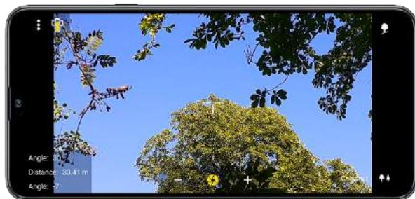
La velocità e la precisione della misurazione sono notevolmente aidate dalla funzione zoom che permette di ingrandire il target sul display. Le fasi di rilievo sono: misurare la distanza dell'albero, quindi l'angolo di base e l'angolo di el vertice. Dai dati così ottenuti, lo strumento calcola e fornisce l'altezza dell'albero.
