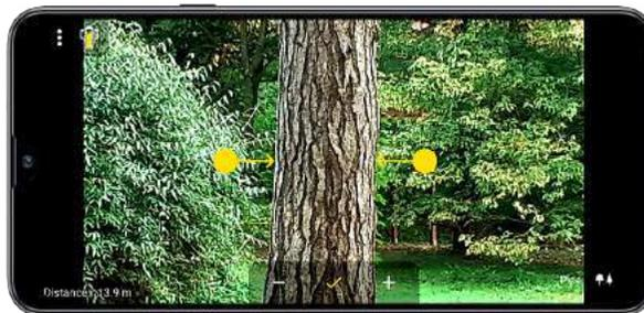
Il dispositivo determina automaticamente il diametro dell'albero all'altezza di misurazione. Tuttavia i punti estremi del diametro possono essere regolati manualmente, anche ingrandendo ulteriormente l'immagine. Ciò consente di eseguire misurazioni ad alta precisione anche da lontano.
